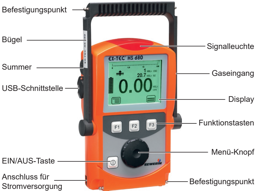
Abb. 1: Geräteübersicht EX-TEC HS 680
